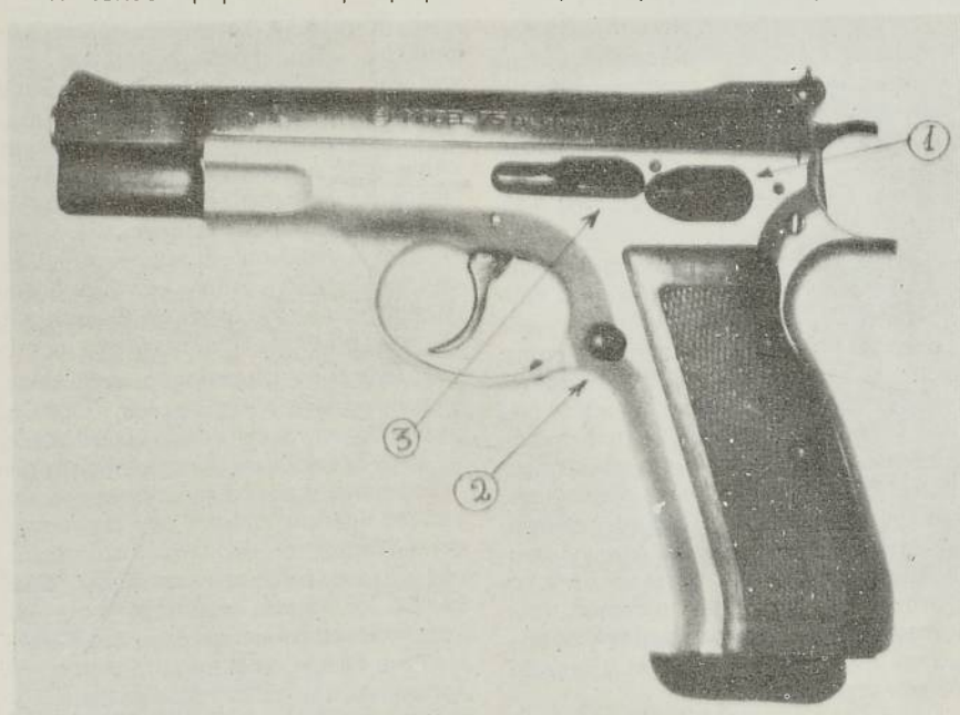
(1) Μοχλός ασφαλείας (2) Ωστήριο απελευθέρωσης γεμιστήρα (3) Μοχλός συγκράτησης του κλείστρου στην ανοικτή θέση.
