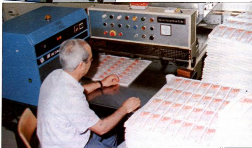
Μηχανή κοπής τραπεζογραμμάτων.
