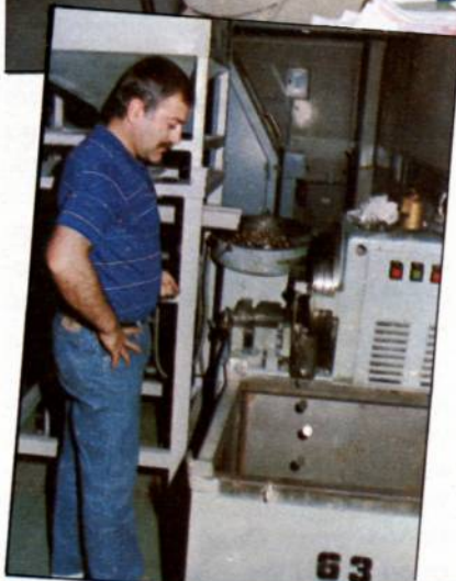
Παραγωγή κερμάτων. Τύπωση στεφάνη στο κέρμα των 20 δρχ.
