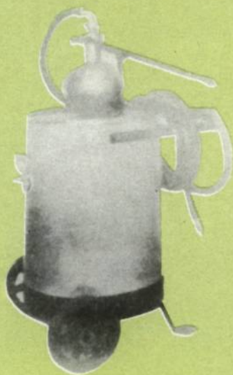
Χειροκίνητη τροχήλατη πυροσβεστική αντλία του τέλους του 19ου αιώνα.
